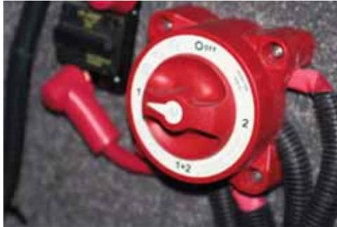
**Figure 4-6. Battery Switch**
